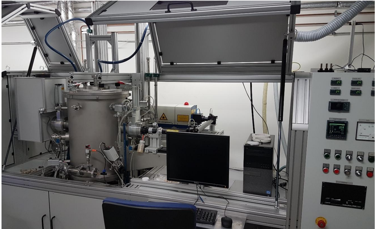
Abbildung 1: Großproben-Laser-Analyse-Anlage (LFA) der Forschungsgemeinschaft Feuerfest e. V. Sie wurde im Haus gemeinsam mit Partnern entwickelt.
