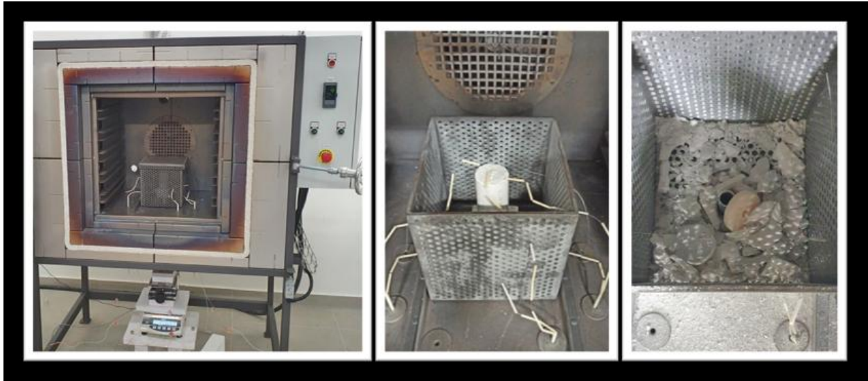
Abbildung 1: MMH-TG-EX Prüfstand, entwickelt von der Forschungsgemeinschaft Feuerfest e. V. (links). Die Probe befindet sich in einem explosions sicheren Käfig (Mitte). Zerstörte Probe nach Versuchsdurchführung (rechts).
