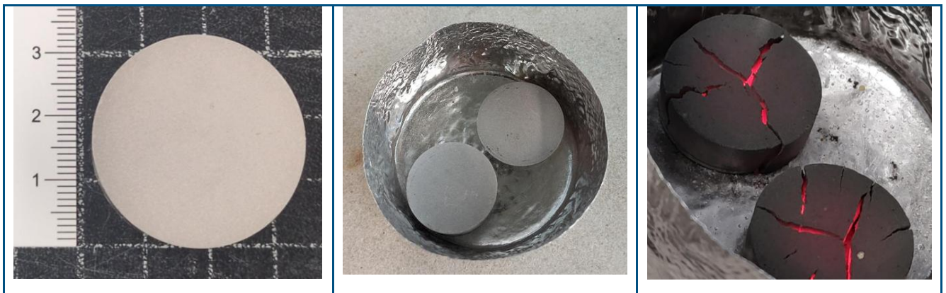
Bild 9 Gepresster Puck aus TR (links), 2 Pucks im Platinbecher vorbereitet für den Brand (Mitte), 2 Pucks im Platinbecher nach dem Brand bei 1450 °C (rechts)
