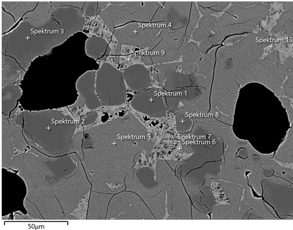
Bild 26 Klinker C-20 (1450 °C), Klinker ausgesaugt und dabei abgeschreckt. Ergebnisse der EDX-Analysen in Tabelle 17 .
