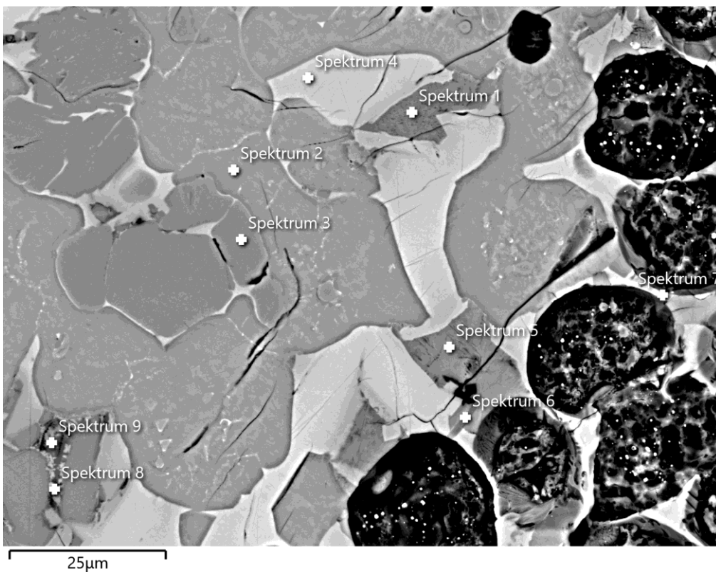
Bild 25 Klinker B-5s, Brand bei 1450 °C (5 min) mit Zusatz von 10 % einer 1:1-molaren \text{Na}_2\text{SO}_4/\text{K}_2\text{SO}_4 – Salzmi- schung in die Rohmehl-Charge. Das Bild zeigt einen mit EDX untersuchten Gefügebereich mit Alit, Belit und Grundmassephasen. Die Ergebnisse der EDX-Analysen sind in Tabelle 16 zusammengefasst. Bei den rundlichen, schwarzen Bereichen rechts im Bild handelt es sich um Freikalk, der bei der Anschliffpräpa- ration durch wasserhaltiges Isopropanol teilweise gelöst wurde und Poren hinterließ, die in der REM- Abbildung schwarz erscheinen. Freikalk in dieser Menge belegt er einen sehr geringen Brenngrad.
