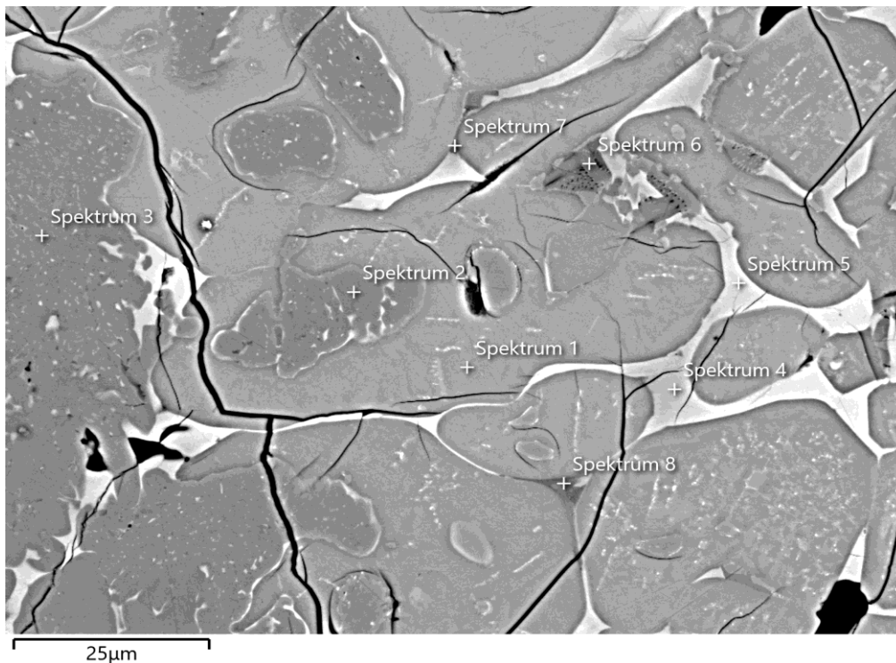
Bild 23 Klinker B-20 (1450 °C). Das Bild zeigt einen Bereich mit Alit, Belit und Grundmassephasen. Ergebnisse der eingezeichneten EDX-Analysen in Tabelle 15 .
