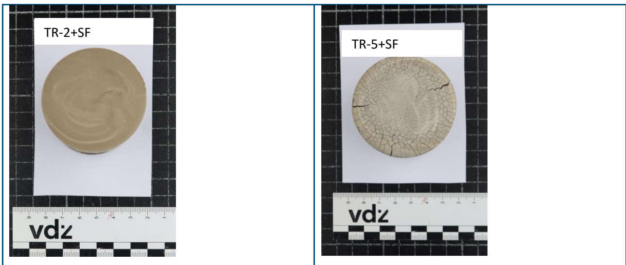
Bild 80 Probekörper „TR-2+SF“ (links) und „TR-5+SF“ (rechts) basierend auf Zementleim nach dem Ausbau aus dem Ultraschall-Messsystem (IP8).
