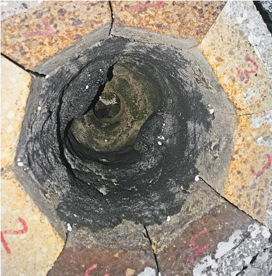
Bild 32 Blick in die Labor-Drehtrommel nach dem Brand von sieben Chargen des Rohmehls TR5. Zu erkennen ist eine Ansatzschicht, die im Bereich der in die Kammer hineinragenden Thermoelement-Schutzhülsen ringförmig verstärkt ist. Nach den Klinkerbränden und der Abkühlung der Drehtrommel fielen die Ansatzschichten beim Ausbau der Segmente regelmäßig fast vollständig ab, weil sie keine feste Bindung zum Feuerfestmaterial entwickeln konnten.
