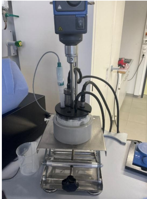
Abbildung 7: Messaufbau zur Messung des zeta-Potentials parallel mit der Messung von pH-Wert, elektrischer Leitfähigkeit und Temperatur. Die Suspension wird permanent gerührt.
