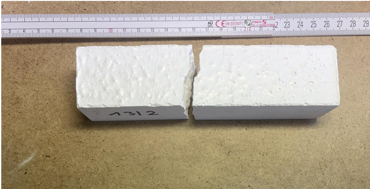
Abbildung 88: Risse an der Oberseite eines Probekörpers aus mit 0,075 Ma.-% PCE verflüssigtem Modell-Feuerbeton (Spezifische Matrix-Oberfläche 3,0 \text{ m}^2/\text{g} und thermischer Vorbehandlung bei 1350 \text{ }^\circ\text{C} ).
