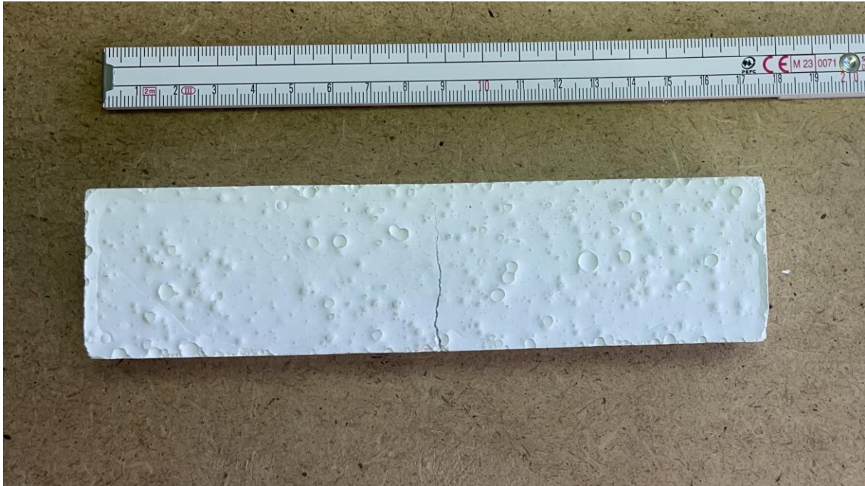
Abbildung 90: Beispiel für einen Probekörper mit sehr poriger Oberfläche in den Versätzen mit einer spezifischen Matrix-Oberfläche von 1,0 \text{ m}^2/\text{g} (Probekörper mit 0,13 Ma.-% PMA und Sinterung bei 1500^\circ\text{C} ).
