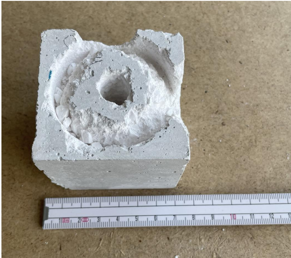
Abbildung 99: Beispiel eines Modell-Feuerbetone, der sich nicht durch Bohren und Sägen bearbeiten ließ.
