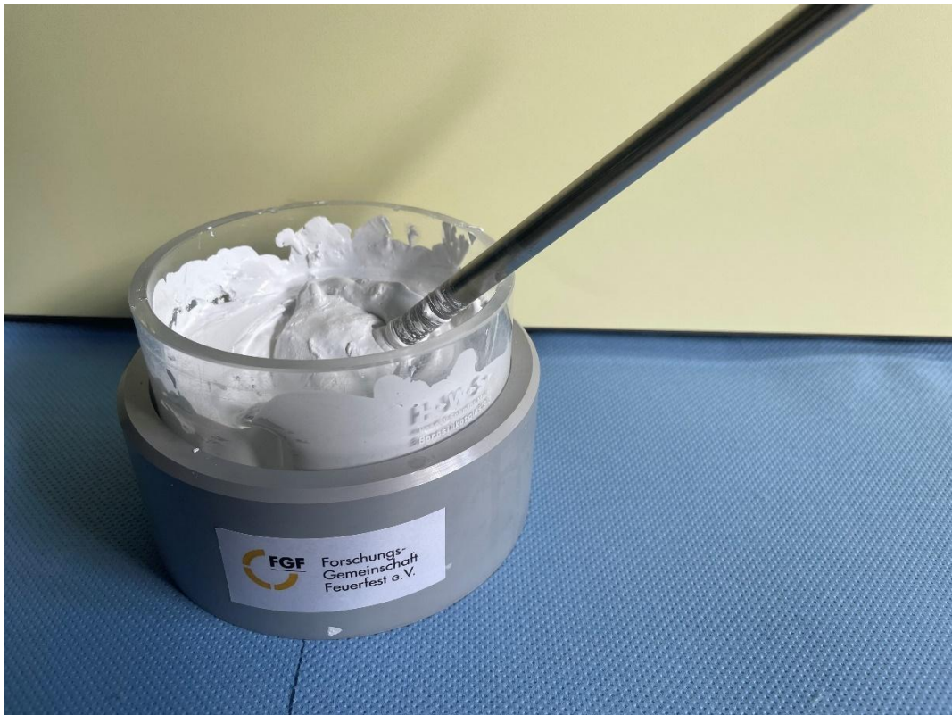
Abbildung 24: Mit PMA + Zitronensäure verflüssigte Suspension nach der Messung des zeta-Potentials.
