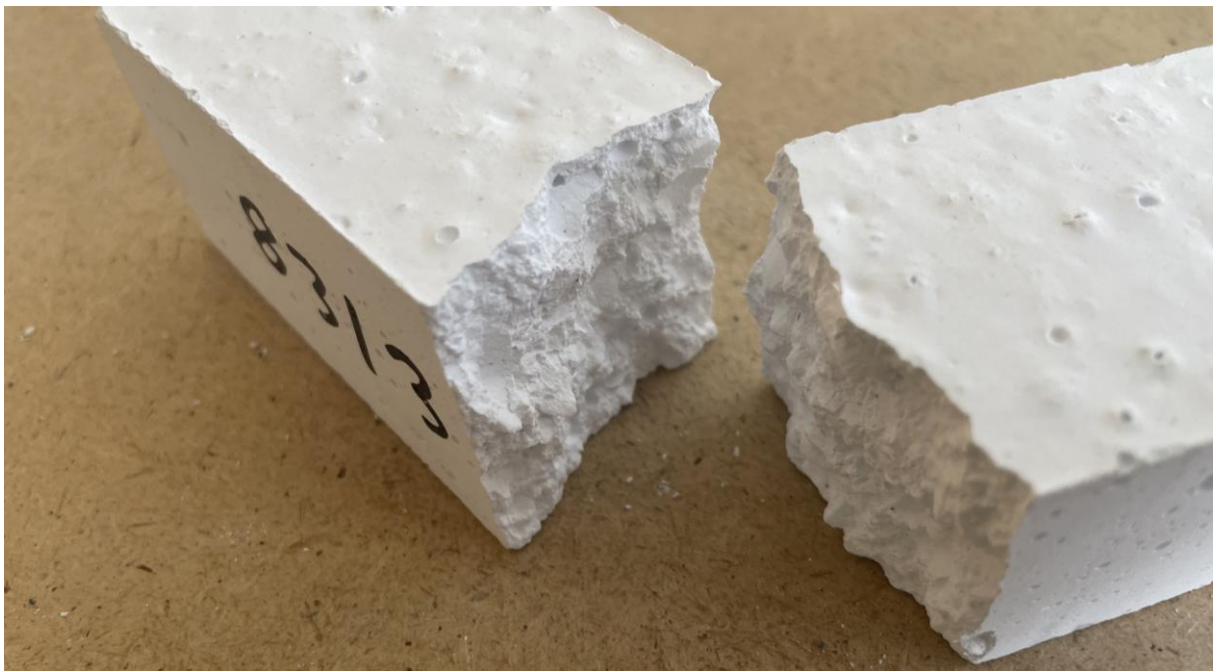
Abbildung 92: Beispiel für eine Bruchstelle eines Probekörpers mit einer spezifischen Matrix-Oberfläche von 1,0 m²/g (Probekörper mit 0,01 Ma.-% Zitronensäure und thermischer Vorbehandlung bei 1500 °C).
