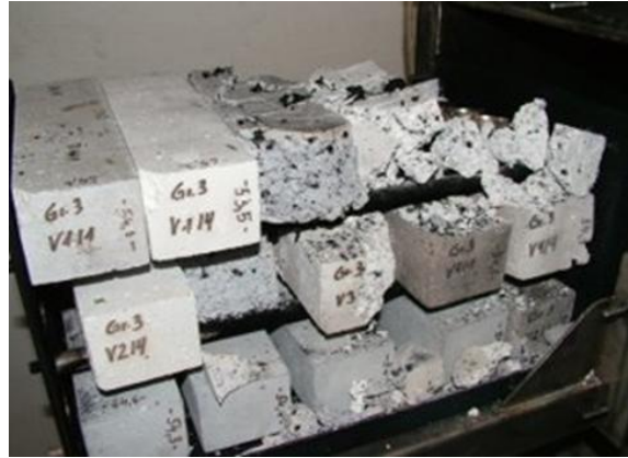
Abbildung 2-1: Typisches Bild von feuerfesten Prüfkörpern mit schlechter CO-Beständigkeit. Die Probenkörper wurden bei 500 °C für 200 Stunden in reiner CO-Atmosphäre ausgelagert. Obwohl es sich um identische Materialien handelt, ist das Ergebnis des Tests gemäß DIN EN ISO 12676 uneinheitlich. Neben stark zerstörten Probenkörpern sind auch intakte Probenkörper zu erkennen.
