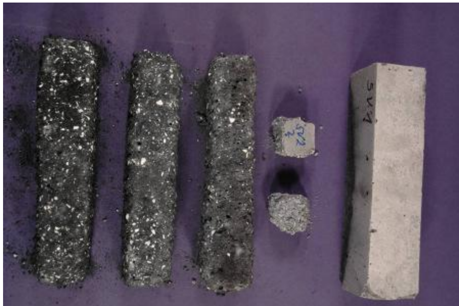
Abbildung 1.2: Mit Hämatit dotierte feuerfeste Prüfkörper nach Auslagerung in Kohlenstoffmonoxid-Atmosphäre. Hämatit-Gehalte von links nach rechts: 0,9 Ma.-%, 0,7 Ma.-%, 0,5 Ma.-%, 0,3 Ma.-% und 0,1 Ma.-%; Die Zerstörung durch Kohlenstoffabscheidung nimmt mit steigendem Gehalt des katalytisch wirksamen Materials (Hämatit) zu [14].
