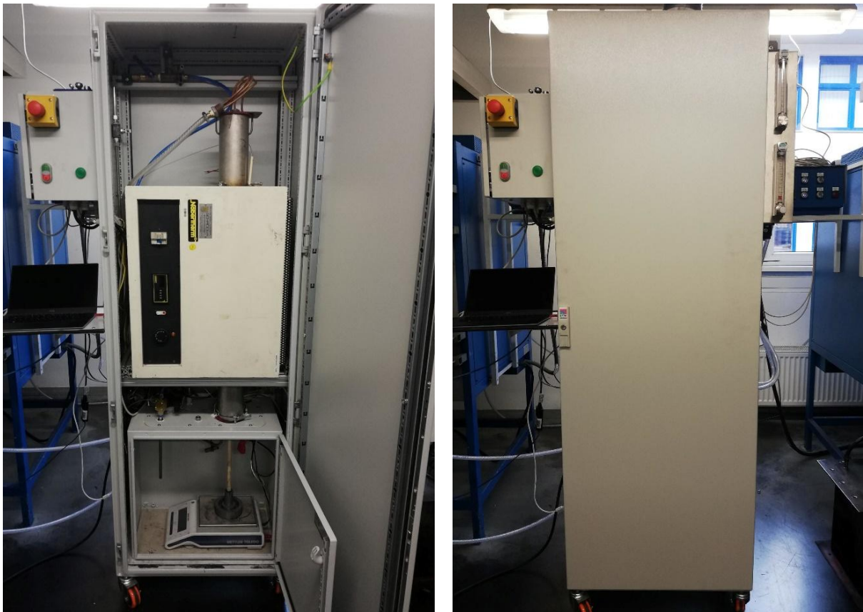
Abbildung 5.4: Entwickelter Prüfstand zur in situ-Ermittlung der Kohlenstoffabscheidungsmenge (links: geöffnet zum Ein- und Ausbau des Probenmaterials; rechts: geschlossener Aufbau zum sicheren Betrieb der Prüfanlage).
