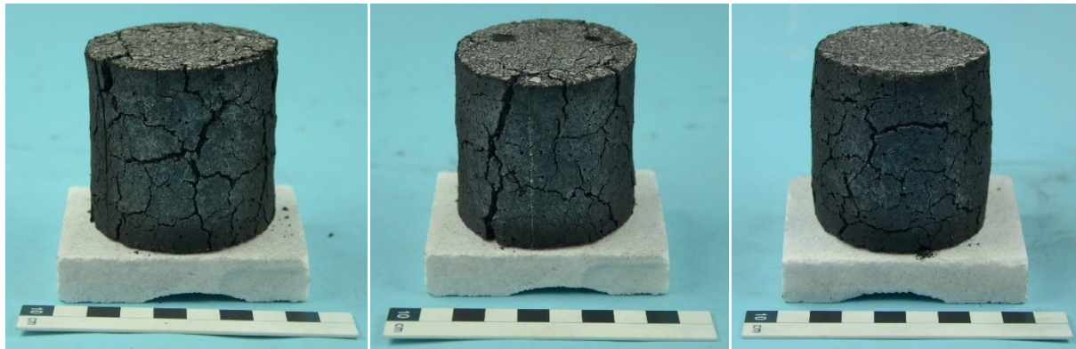
Abbildung 7.1: Zylindrische Feuerbeton-Pröben mit einem Hämatit-Gehalt von 0,25 Ma.-% nach Auslagerung für 50 h in Kohlenstoffmonoxid-Atmosphäre bei 500 °C. Links: Auslagerung bei einer CO-Durchflussrate von 10 l h -1 ; Mitte: Auslagerung bei einer CO-Durchflussrate von 20 l h -1 ; Rechts: Auslagerung bei einer CO-Durchflussrate von 40 l h -1 ; Alle Prüfkörper weisen starke Rissbildung an der Oberfläche und eine deutlich sichtbare Volumenexpansion auf.
