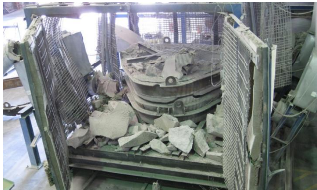
Bild 1: Herdwagen nach Explosion eines Bauteils aus CAC-Feuerbeton beim Aufheizen.
